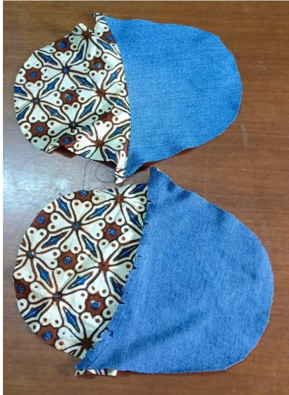
Gambar 4. Potongan uppe yang sudah dijahit dengan kain furing (Dokumentasi pribadi, 2019)
