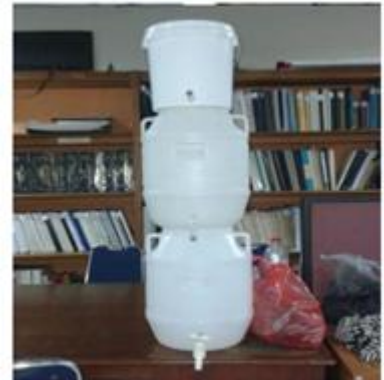
Hasil Akhir Pemasangan Pipa Pada Wadah Filtrasi
