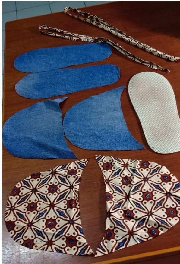
Gambar 3. Potongan alas, upper, kain furung, dan bisban (Dokumentasi pribadi, 2019)
